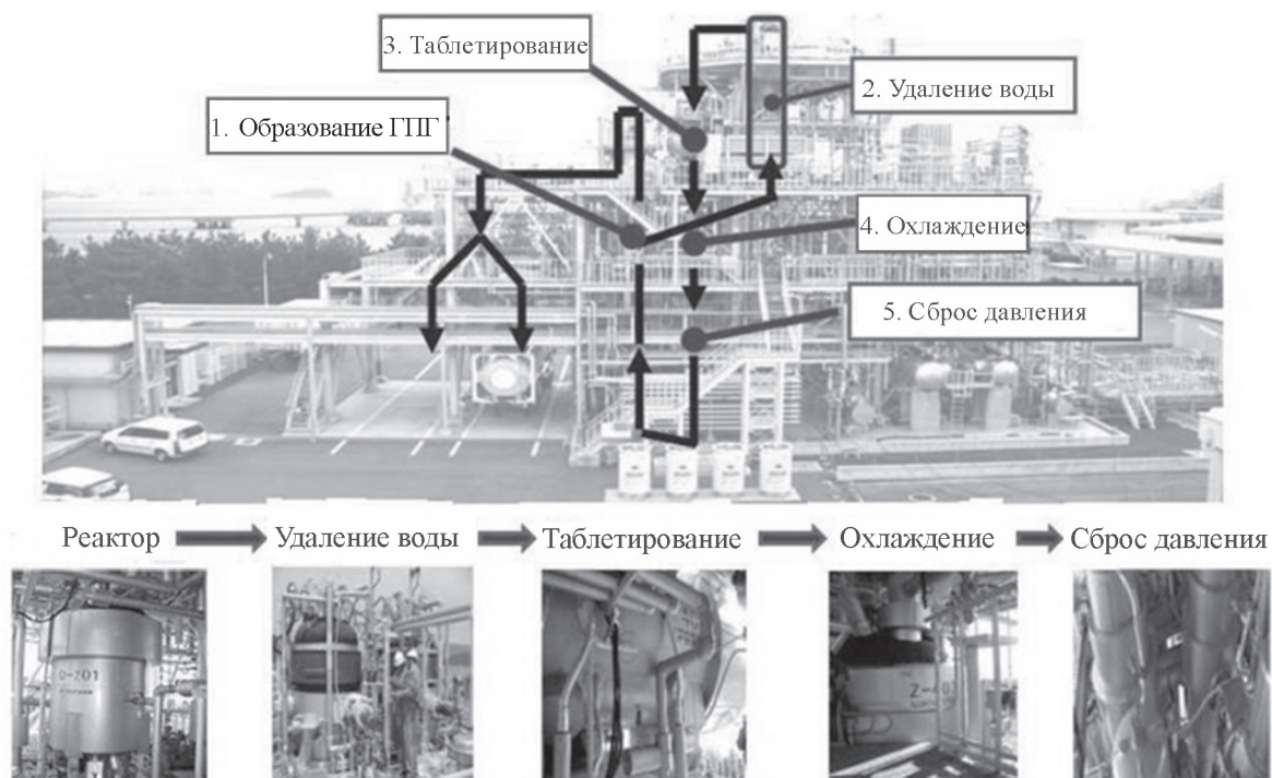
Рис. 4. Опытно-промышленный завод в Японии по получению гидратных пеллет [13].
